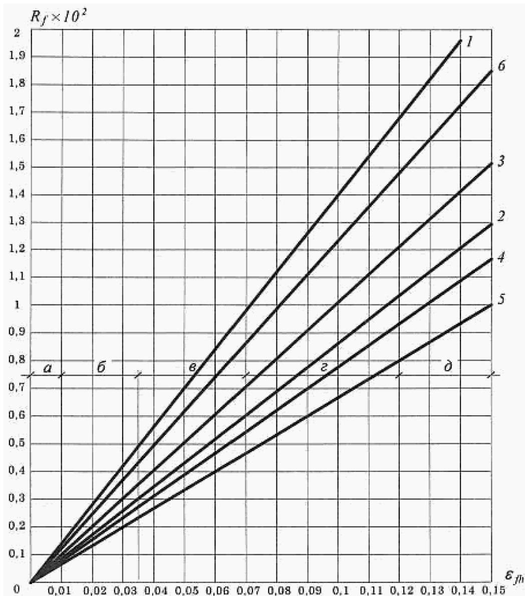
1, 2 - супеси; 3 - суглинки; 4 – суглинки с  $0,07 < I_p \leq 0,13$ ; 5 - суглинки с  $0,13 < I_p \leq 0,17$ ; 6 - глины
