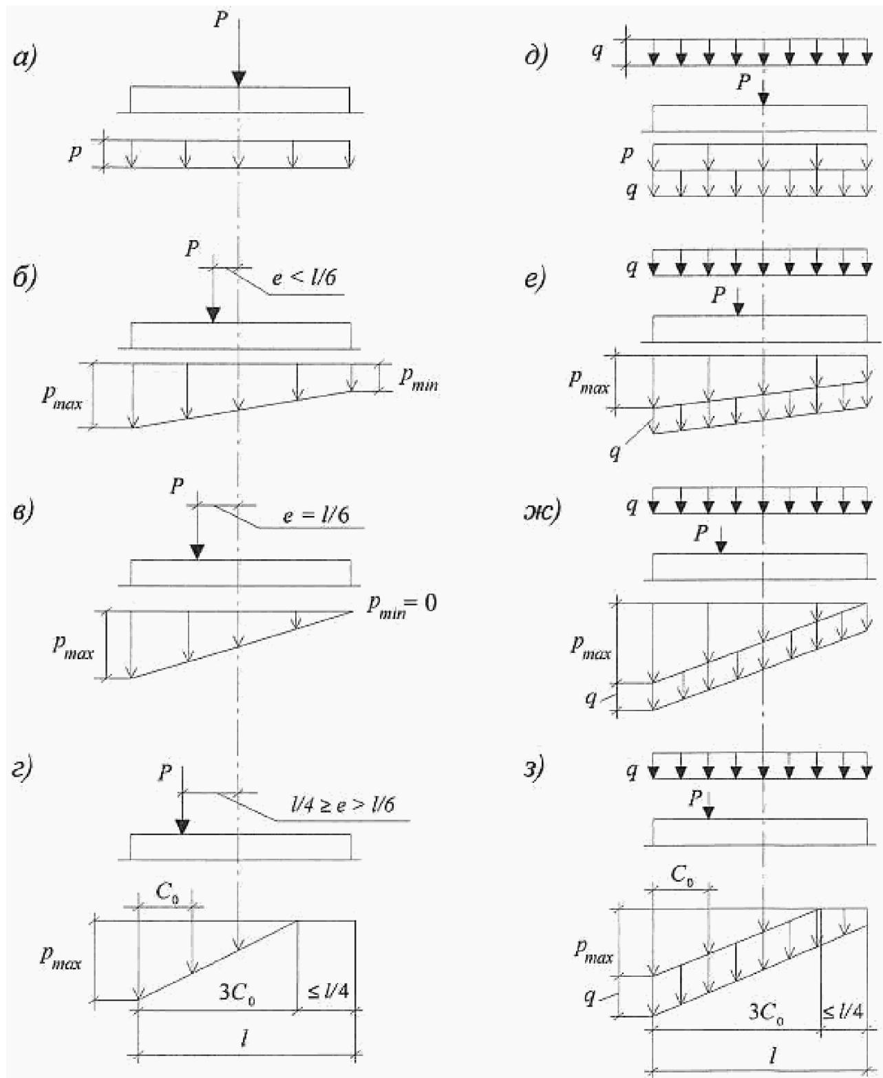
а - г - при отсутствии нагрузок на полы; д - з - при сплошной равномерно распределенной нагрузке интенсивностью  $q$ ; а и д - при центральной нагрузке; б и е - при эксцентричности нагрузки  $e < l/6$ ; в и ж - при  $e = l/6$ ; г и з - при  $e > l/6$  (с частичным отрывом фундамента от грунта)
