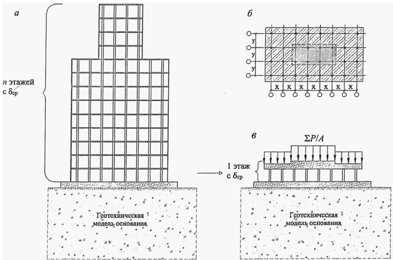
а - исходное здание с n-м числом этажей; б - план здания, разбитый на высотные участки; в - вид эквивалентного по жесткости этажа для выполнения расчетов n - число этажей со средней толщиной плиты перекрытия  $\delta_{ср}$ ;  $\delta_{пр}$  - приведенная толщина плиты перекрытия;  $\Sigma P$  – сумма сил, действующих на участок площадью А
