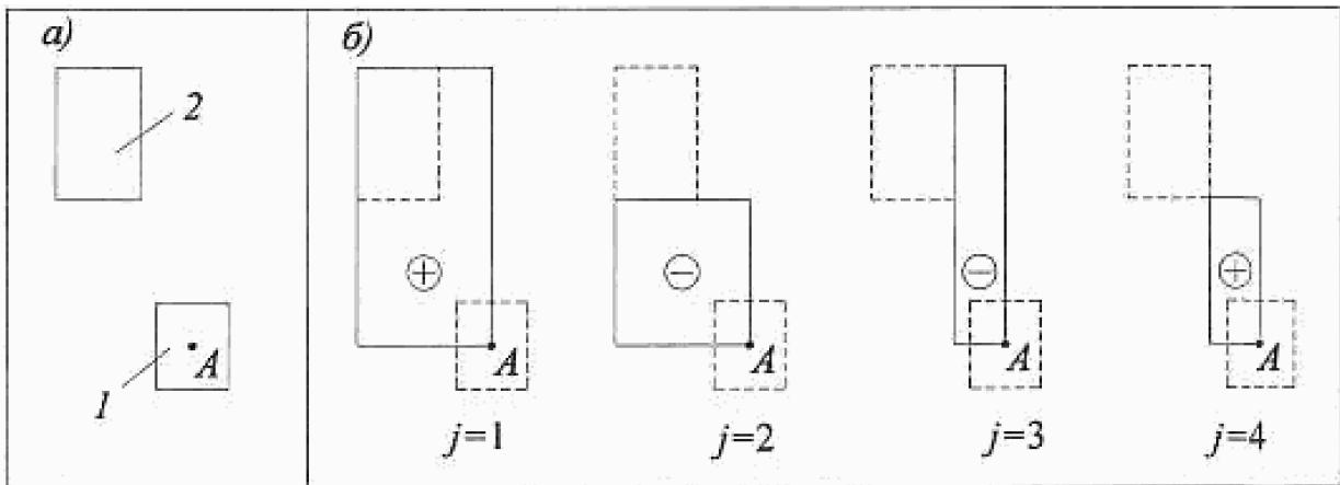
а - схема расположения рассчитываемого 1 и влияющего фундамента 2; б - схема расположения фиктивных фундаментов с указанием знака напряжений  $\sigma_{zp,cj}$  в формуле (5.21) под углом  $j$ -го фундамента
