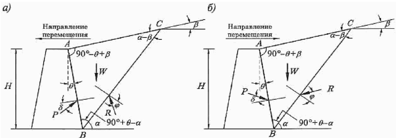
Рисунок 9.2 - Схема к определению величин а) активного, б) пассивного давлении грунта при негоризонтальной поверхности грунта и наклоне грани конструкции к вертикалам
