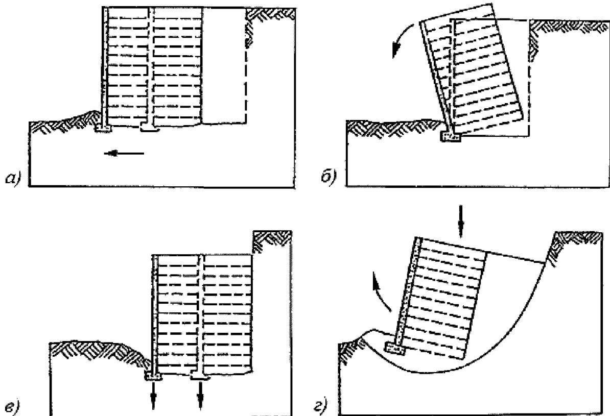
а - сдвиг по подошве; б - опрокидывание; в - потеря несущей способности подстилающего массива грунта; г - глубинный сдвиг
